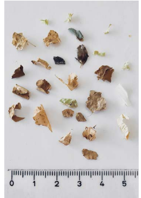
Kuvassa tuotantolaitoksen kiinteässä jäännöksessä esiintyvä muovi seulonnan jälkeen. Muovimäärä on keskimäärin 4,4 cm 2 litraa kohti.
