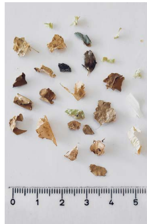
Bild på mängden plastbitar som finns kvar i en liter slutprodukt efter att den sällats. Detta får man inte bort. Mängden plast är i medeltal 4,4 cm 3 per liter slutprodukt.
